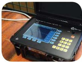
В службу наладки, испытания, измерения электрооборудования поступил рефлектометр для силовых линий TDR-109 СТРИЖ-С российского производства.
